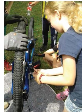
ist, muss mittels Reifenheber der Reifen von der Felge gehoben werden, um den Schlauch herausnehmen zu können. Hierbei an der dem Ventil gegenüberliegenden Seite beginnen. Tipp: am besten gleich jetzt den gesamten Reifen von der Innenseite auf eventuell noch drin steckenden Fremdkörper abtasten – damit dieser nicht nach Zusammenbau erneut darin ein Loch verursacht.
